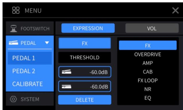
**Réglez la pédale interne** : sélectionnez PEDAL 1 dans la partie gauche, puis sélectionnez EXPRESSION dans la partie supérieure ; le voyant DEL EXP s'allume. Sélectionnez le module, les paramètres et la gamme que vous souhaitez contrôler. Une fois le réglage terminé, le paramètre est mis en surbrillance. Vous pouvez alors contrôler le paramètre en déplaçant la pédale d'expression externe.
